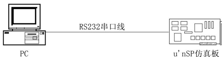
图8.30 卷积编译码通信实验框图
